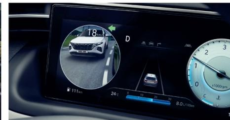
Tableau de bord digital de 10,25" avec régulateur de vitesse intelligent et affichage des angles morts par caméra.
