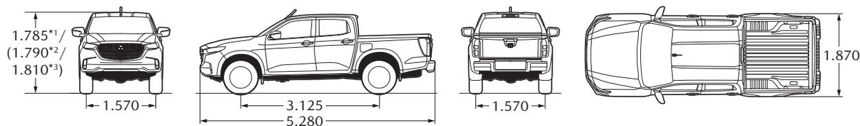
Unité: mm \*1 Avec pneus 255/65R17 \*2 Avec pneus 265/60R18 \*3 Avec pneus 265/60R18 et barres de toit. Photos non contractuelles.
