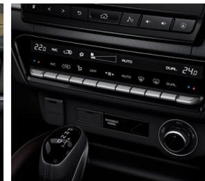
Climatisation bizona à contrôle automatique de la température.
